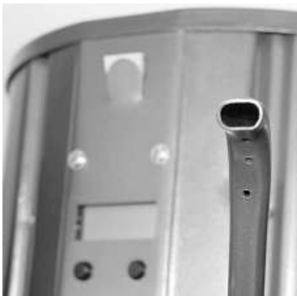
Fig. 3: ein Detail des Luftauslasses eines Luftdüsenarms
